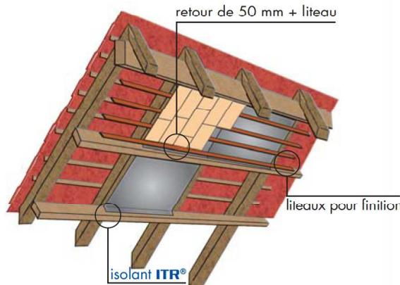
> Attention : l'installation d'un parement de protection est obligatoire pour les combles aménagés. Elle doit être effectuée par une entreprise agréée ou par du personnel qualifié, selon les normes en vigueur et le cahier des charges du fabricant.
